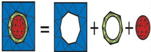
Figure 7 : Maillage Birésolution composé de tétraèdres grossiers (en bleu), de tétraèdres fins (en rouge) et de tétraèdres de lien assurant la jonction (en vert).
